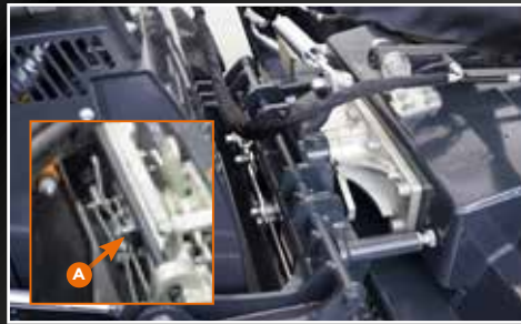
Frontheber mit Schnellbefestigung mit Sicherheitshebel (A)
