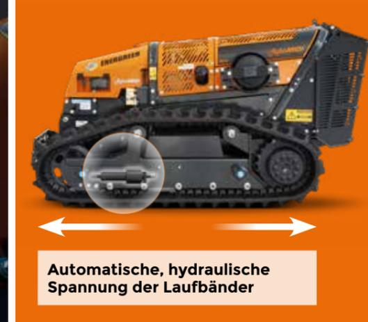
Automatische, hydraulische Spannung der Laufbänder
