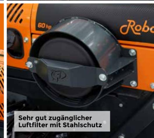
Sehr gut zugänglicher Luftfilter mit Stahlschutz
