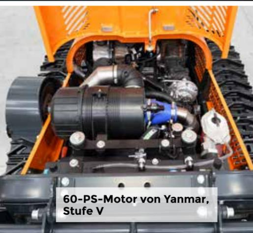
60-PS-Motor von Yanmar, Stufe V
