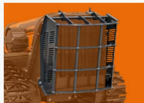
Klappbarer Kühlerschutz aus Stahl
